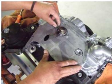
④ ②で外したストレーナー取り付けボルトで製品を共締めして下さい。
